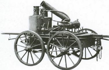
Esta caldera dispone de unas válvulas que permiten el paso del vapor por todo el recorrido que ha de efectuar el agua ya purificada esterilizándolo en la puesta en marcha. Dispone además, de todos los elementos reglamentarios y de un regulador de presión patentado que impide pase la presión del límite marcado.
